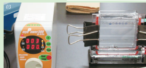
03. ポリアクリルアミドゲル電気泳動。電気泳動装置を用いて電流を流すことで、試料中のたんぱく質を分子量の大きさに分離することができます。
